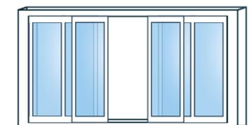
COULISSANT 6 VANTAUX 3 RAILS Une ouverture maximale sur l'extérieur pour un maximum de lumière. Idéal pour les très grandes ouvertures
