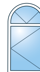
Châssis 1 vantail avec imposte plein cintre
